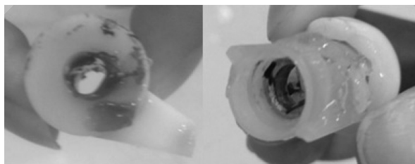
图 1 阻尼器漏油照片
