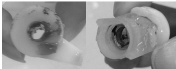
图 1 阻尼器漏油照片
